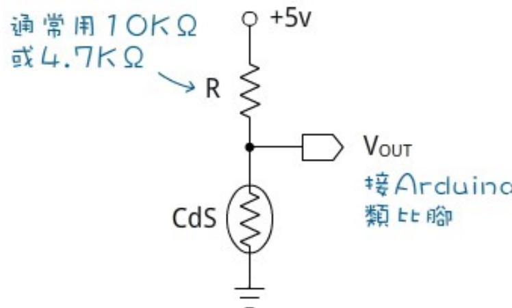
$$V_{OUT} = 5\text{V} \times \frac{R}{R + CdS}$$
